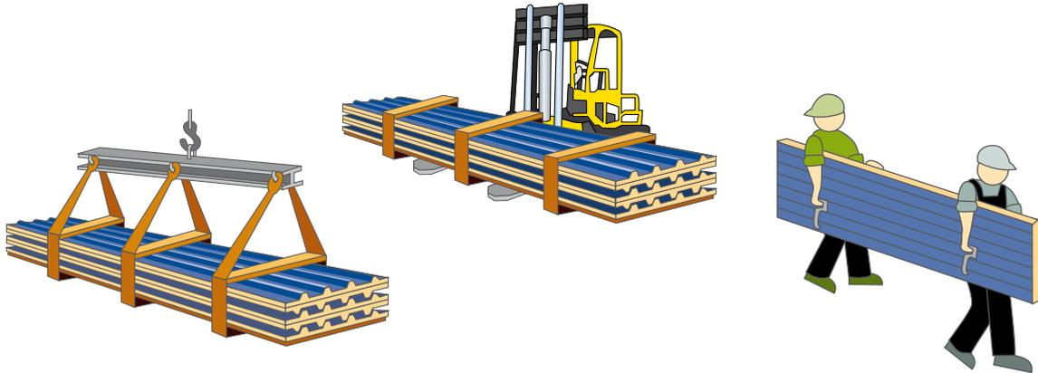
Beim Transport auf der Baustelle sind die Profile grundsätzlich vom Stapel abzuheben und hochkant von mindestens zwei Personen zum Einbauort zu tragen. Um Beschädigungen an der hochwertigen Oberfläche zu vermeiden, dürfen die Profile niemals über bereits verlegte Flächen oder scharfe Kanten gezogen werden.
