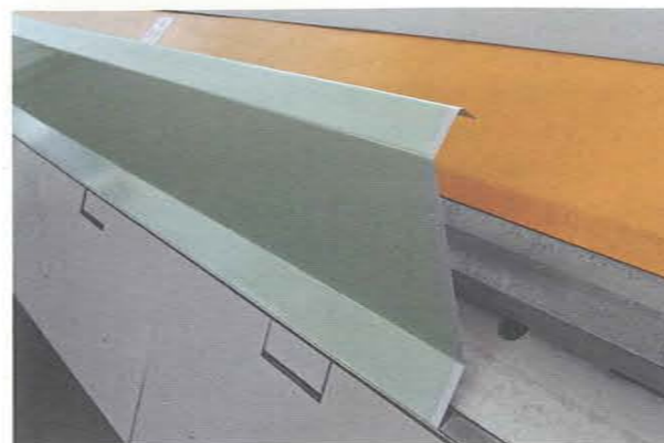
Die Funktion des Positiv- und Negativbiegens macht ein Wenden des Blechs überflüssig.
