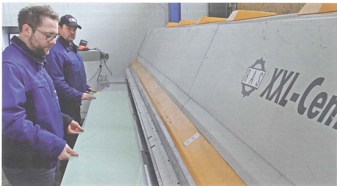
Tische, die aus der Maschine herausfahren, erleichtern das Einlegen der Werkstücke.
